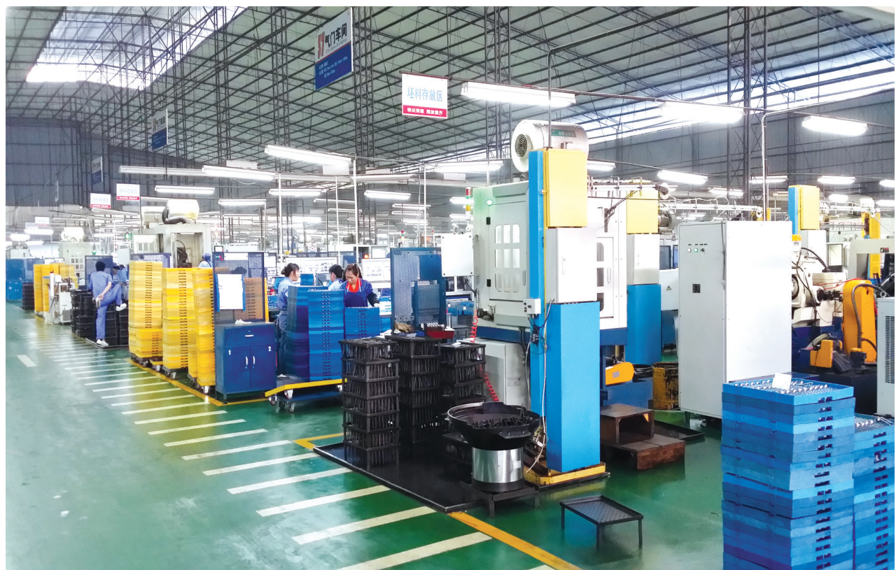
081电子集团天源机械有限公司气门柔性加工生产线。气门柔性加工设备成套系统的创新实践,实现了气门的自动化、智能化生产和气门的高效、低成本制造。气门柔性加工生产线技术已获得5项国家专利,其中4项发明专利。(市经信委供图)
